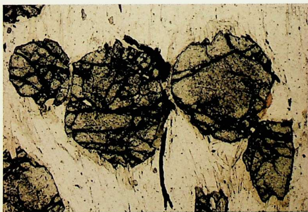
Fig. 8 - Microfoto dei micascisti della galleria ENEL in Val Taviela. In una massa di fondo orientata spiccano grossi cristalli di granato (scuro) intensamente fratturati. Polarizzatori paralleli, 45x.
