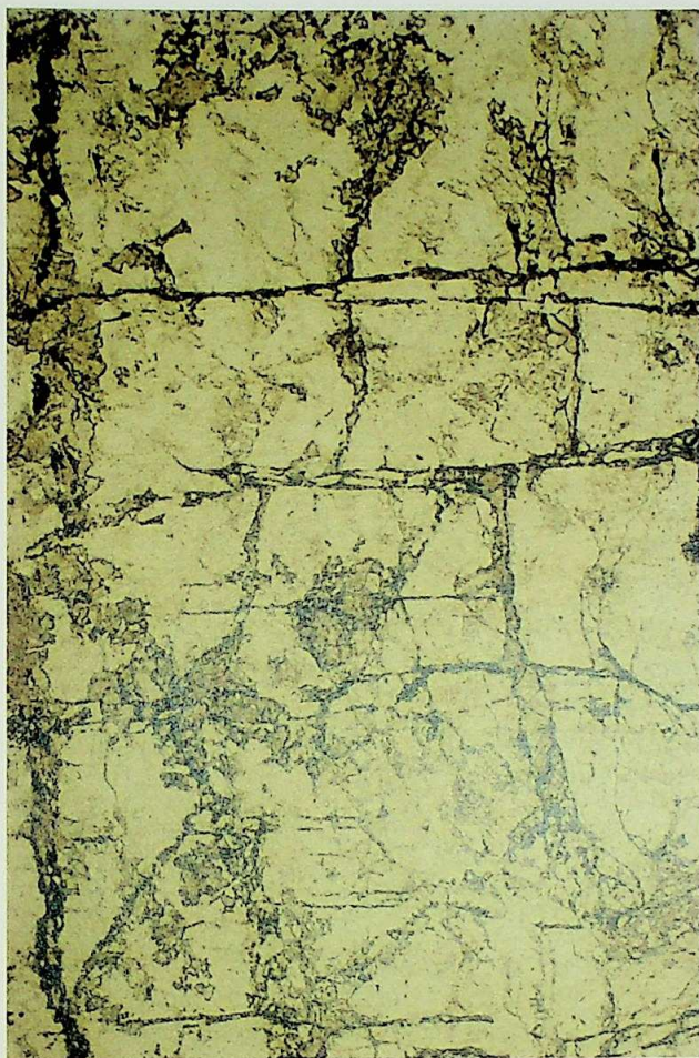
Fig. 4 - Milonite della linea di Peio. Massa di fondo quarzosa con filoncelli idrotermali di calcite (verticali) tagliati dai filoncelli di pirite (orizzontali). Polarizzatori paralleli. Larghezza del preparato: 2 mm.
